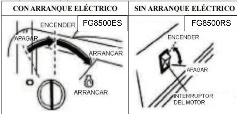
Coloque la llave en la posición ON así que el generador arranque. No utilice el arranque por más de 5 segundos de una solo vez. Si el motor no arrancar, largue el interruptor y espere 10 segundos antes de repetir la operación.
