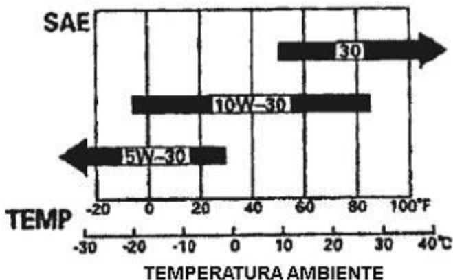
Use aceite de 4 tiempos, o detergente alto equivalente, aceite de motor de calidad superior certificado para cumplir o exceder los requisitos del fabricante de automóviles de EE. UU. Para la
